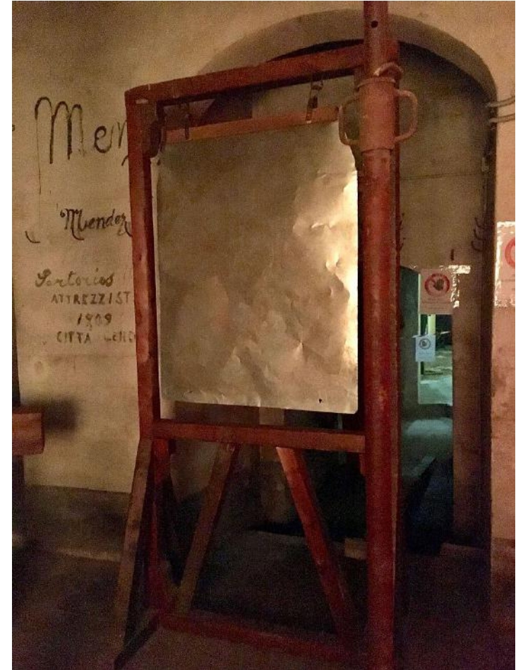
Machine à tonnerre
